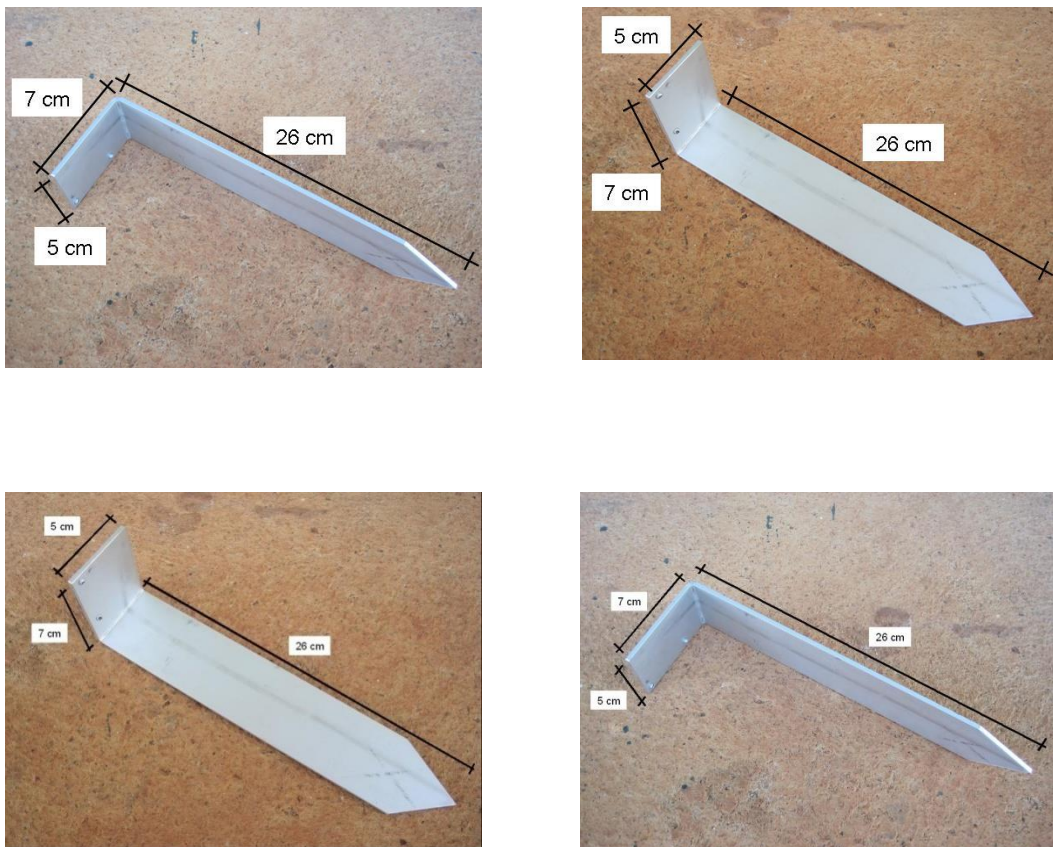
Figura 1: Especificações da barra de alumínio
